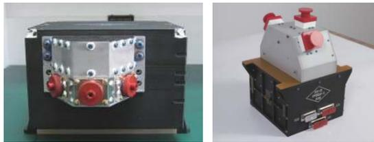
(a) 北斗卫星中能电子探测器 (b) “风云4号”02星中能质子探测器
