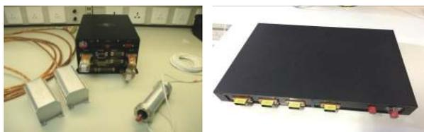
(a) 电磁试验卫星磁强计 (b) 激光光泵原子磁力仪
