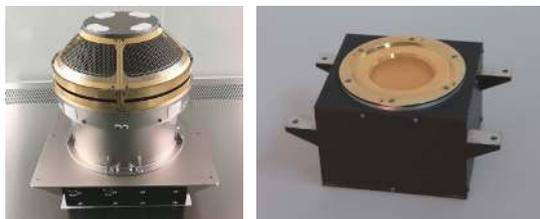
(a) “天问1号”火星离子与中性粒子分析仪 (b) 电磁试验卫星等离子体分析仪
